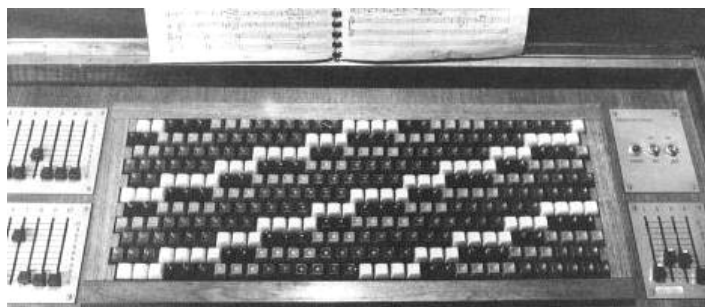
Abbildung 11: Herman van der Horst: Archiphon (1970). Elektronische Version der von Adriaan Fokker gebauten Euler-Fokker-Orgeln von 1943 bzw. 1951 (siehe http://www.xs4all.nl/huygensf/english/index.html )
